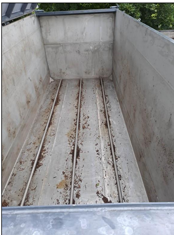
Obrázok 10 Pohľad kontajnera z vnútra s prevzdušňovacími trúbkami. Spracovanie nie je založené na technologickom tepelnom spracovaní
